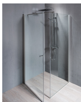
Duššinurk + klaasuks: Form või analoogne toode / kirkas klaas / anodeeritud alumiiniumprofiil / h1900 või h2000mm / Balteco *Täpne duššinurga lahendus Vt. san.ruumi jooniselt
